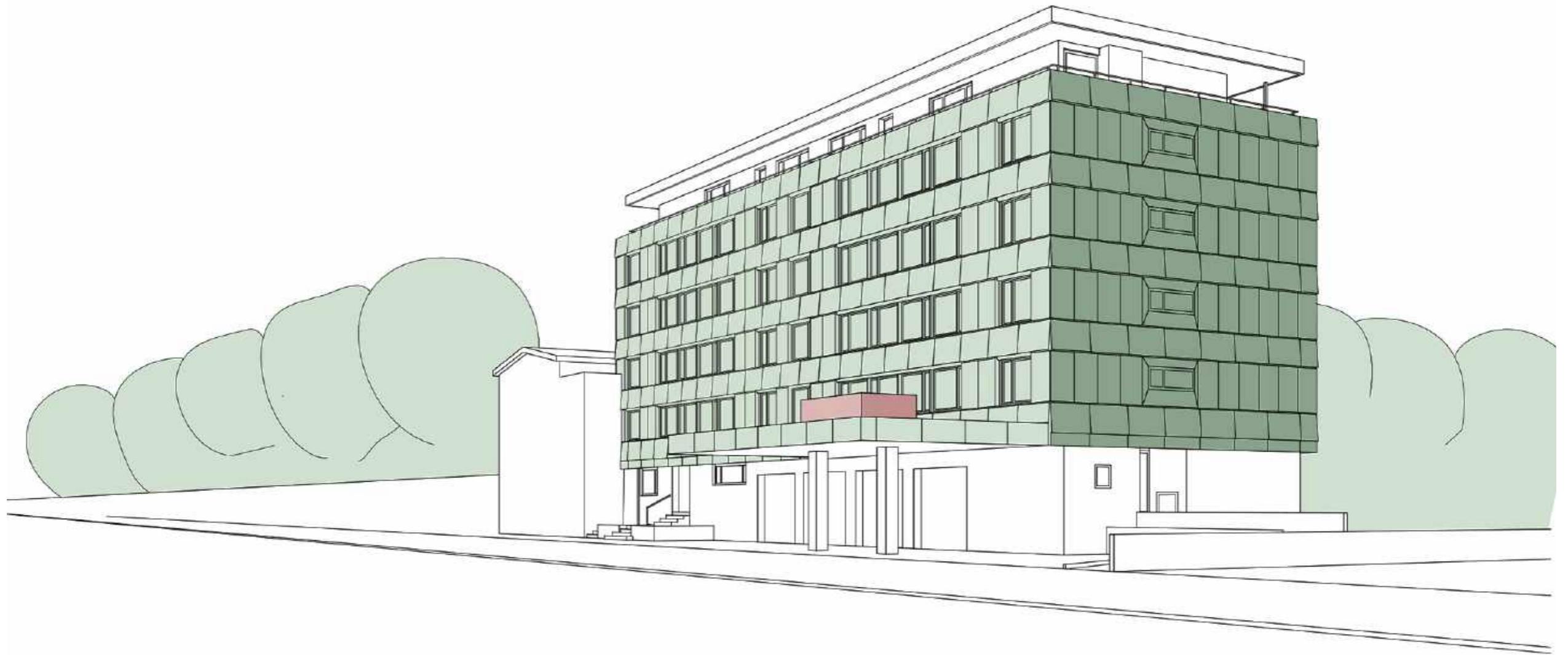
PV Fassade aus Standardelementen 100 × 167 cm, dunkelgrün (RAL 6009)
