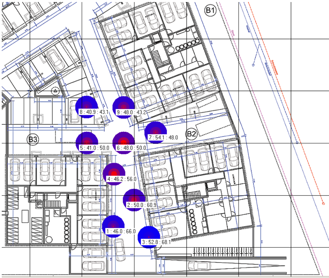
Abb. 5: Zentrale Sondenordnung mit 7m Sondenabstand, Eingabemaske im Programm EWS
